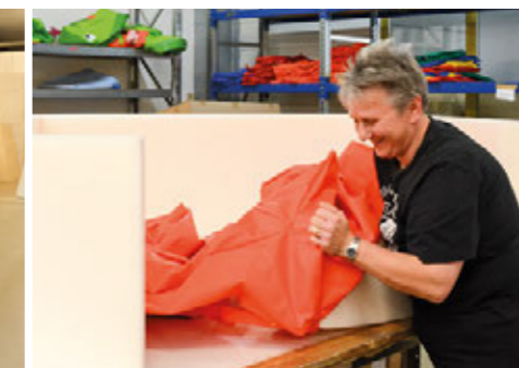
Die Schaumstoffe werden von Hand bezogen.
